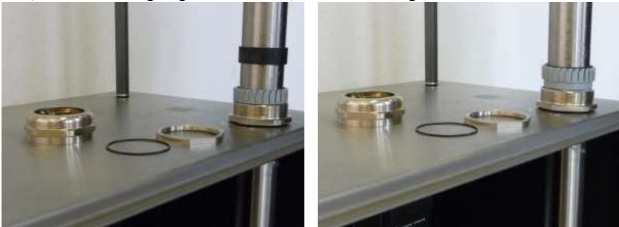
Abbildung 13 A+B: Äußere Fixierung des Probenahmerohres
