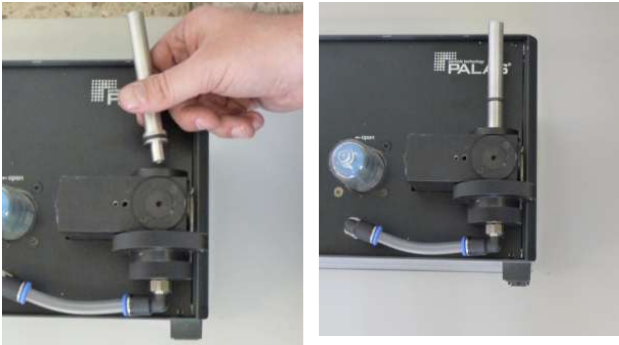
Abbildung 14 A+B: Anbringen des Aerosoleinlassführungsrohres
