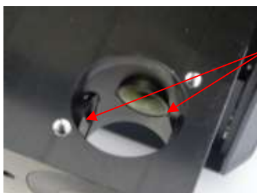
Abbildung 34: Optische Gläser im Innern des Aerosolsensors
