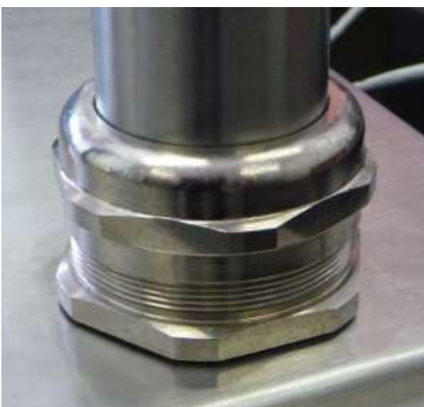
Abbildung 20 A+B: Abschließende Fixierung des Probenahmerohres
