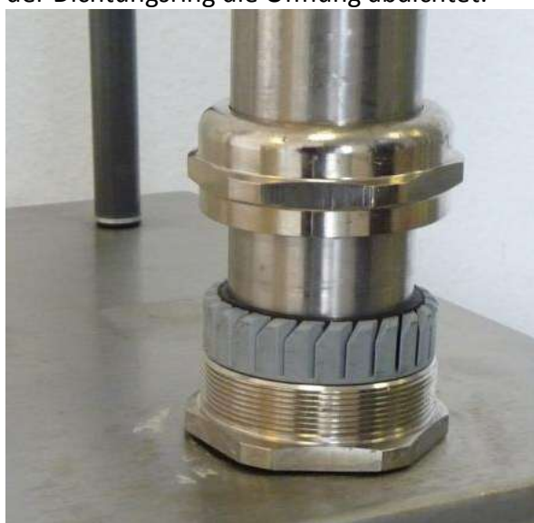
Abbildung 20 A+B: Abschließende Fixierung des Probenahmerohres
