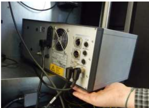
Abbildung 16: Verbinden der Wetterstation, IADS mit den Anschlüssen auf der Rückseite
