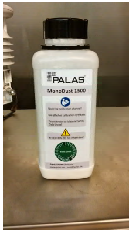
Abbildung 22: MonoDust 1500 zur Verifizierung / Kalibrierung der Empfindlichkeit
