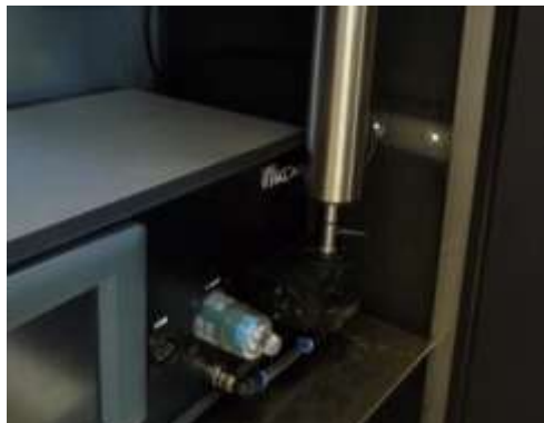
Abbildung 30: Verbindung des Sensoreingangs mit Feuchtekompensationsmodul IADS
