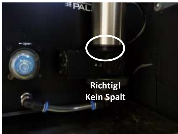
Abbildungen 18 A+B: links falsche Position des Probenahmerohres, rechts richtige Position
