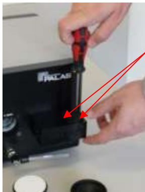
Abbildung 32: Lösen der M3 Kreuzschlitzschrauben
