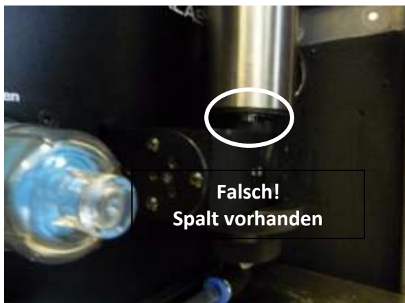
Abbildungen 18 A+B: links falsche Position des Probenahmerohres, rechts richtige Position
